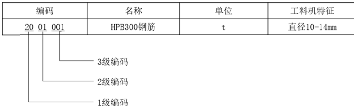
图 6.5.1 HPB300 钢筋的编码组成示意图：
